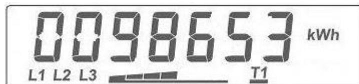
Aktiivtarif – **T1 (Öö)**, kuvatud väärust **98653 kWh** kehtib tariifiga **T1 (Öö)**; kõik faasid on olemas **L1, L2, L3**; hetkvõimsus ligikaudu **384 W**.
