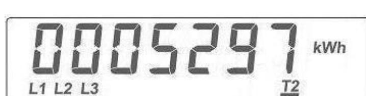
Aktiivtarif – **T2 (Päev)**, kuvatud väärust **5297 kWh** kehtib tariifiga **T2 (Päev)**; kõik faasid on olemas **L1, L2, L3**; **puudub bargraafi** sümbol – kõikides faasides voolude summa on väiksem rakendusvoolust **15mA**.
