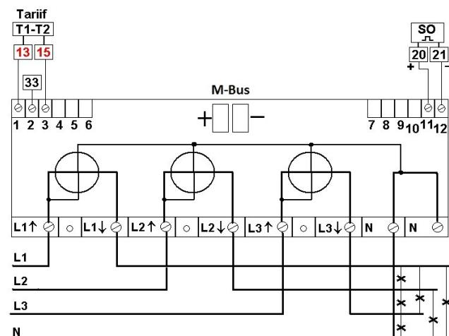
Elektrienergia arvesti otseühendusega tüüp **ED 310 DB** on varustatud LCD displeiga ja **M-Bus** väljundiga. Peale elektrienergia arvesti ühendamist elektrivõrguga toimub umbes 1s jooksul kõikide LCD segmentide testimine.
