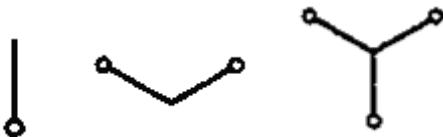
Эти обозначения, указывают, что счётчик имеет мультифазное подключение, то есть может работать как в однофазном режиме L-N (двупроводная система,  $U = 230V[AC]$ ), так и на 2-х фазах « $L_x$ », « $L_y$ » и нейтралью «N» (сети  $3 \times 230 / 400V$ ), или, стандартной трёхфазной четырёхпроводной сети  $3 \times 230 / 400V$ . При этом выбор фаз (L1, L2, или L3) значения не имеет.
