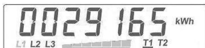
Aktiivtarif – **T2 (Päev)**, kuvatud väärust **29165 kWh** kehtib tariifiga **T1 (Öö)**; «**vilkuv**» **sümbol** faas **L1** ja **bargraaf** – näitab tagasivoolu (energia vörku) faasis **L1**.
