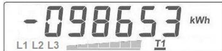
Aktiivtarif – **T1 (Öö)**, kuvatud väärust **-98653 kWh** kehtib tariifiga **T1 (Öö)**; «**vilkuv**» **sümbolid** faas **L1, L2, L3** ja **bargraaf** – näitab tagasivoolu (energia vörku) faasis **L1, L2, L3**
