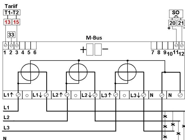
Электросчётик прямого подключения типа **ED 310 DB** оснащен LCD дисплеем и дополнительно **M-Bus выходом**.
