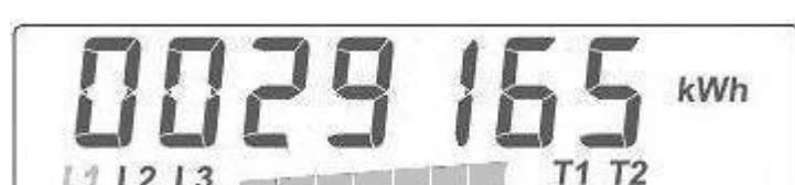
Aktiivtarif – **T2 (Päev)**, kuvatud väärthus **29165 kWh** kehtib tariifiga **T1 (Öö)**; **«vilkuv» sümbol** faas **L1** ja **bargraaf** – näitab tagasivoolu (energia vörku) faasis **L1**.
