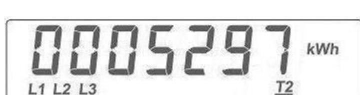
Aktiivtarif – **T2 (Päev)**, kuvatud väärthus **5297 kWh** kehtib tariifiga **T2 (Päev)**; kõik faasid on olemas **L1, L2, L3**; **puudub bargraafi** sümbol – kõikides faasides voolude summa on väiksem rakendusvoolust **15mA**.
