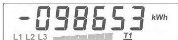
Aktiivtarif – **T1 (Öö)**, kuvatud väärthus **-98653 kWh** kehtib tariifiga **T1 (Öö)**; **«vilkuv» sümbolid** faas **L1, L2, L3** ja **bargraaf** – näitab tagasivoolu (energia vörku) faasis **L1, L2, L3**
