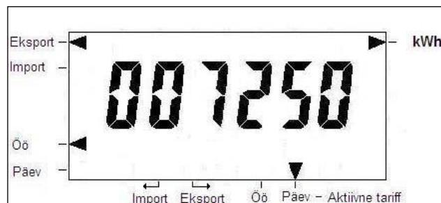
Aktiivne tariif – Päev, energiavoog ei ole fikseeritud – ei ole kuvatud bargraaf – s.t. voolu suurus on väiksem käivitusvoolust **15mA**, kuvatud energia **7250 kWh** kehtib tariifiga Öö / energiavoog **Eksport (tarbimine)**.
